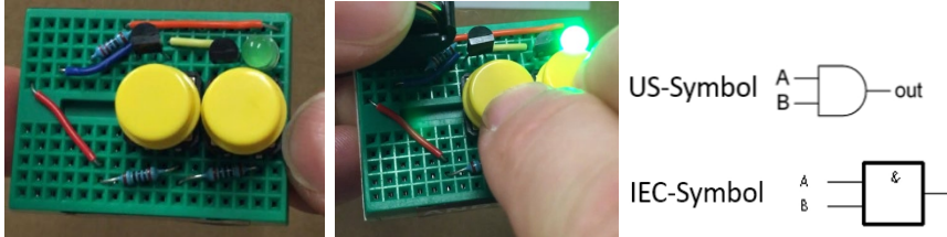
Abbildung 47 AND-Gatter: Nur beide Knöpfe ergeben Licht (Wahr) Bilder © Knoll
